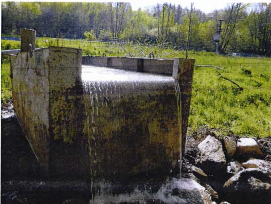
Foto 5: Abfluss von 75 m<sup>3</sup>/h während des PV aus dem Absetzcontainer über die Steinpackung in die Bracht am 04.05.2023.
