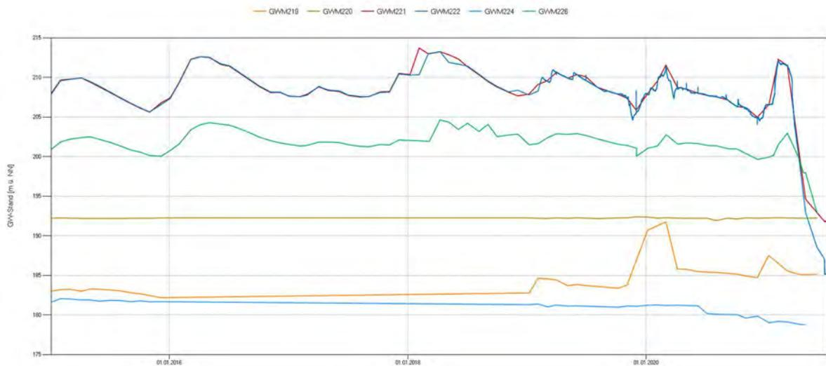
Abb. 3: Längerfristige Ganglinien von Grundwassermessstellen im weiteren Umfeld der Brunnenbohrung (WG Neuenschmidten-Nord). In jüngerer Zeit zeichnen sich Tendenzen in Richtung fallender Grundwasserstände, vor Allem im oberen Buntsandstein, ab.
