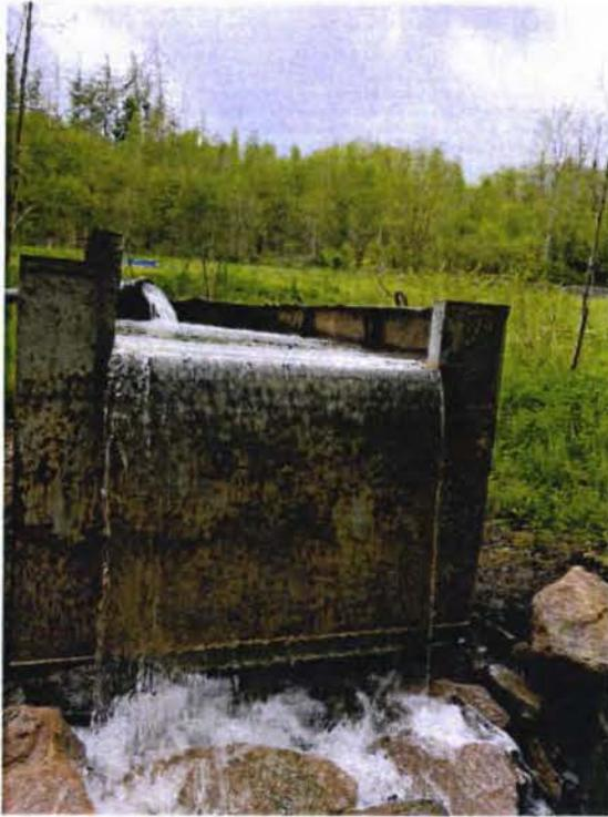
Foto 6: Abfluss von  $90 \text{ m}^3/\text{h}$  während des PV aus dem Absetzcontainer über die Steinpackung in die Bracht am 08.05.2023.
