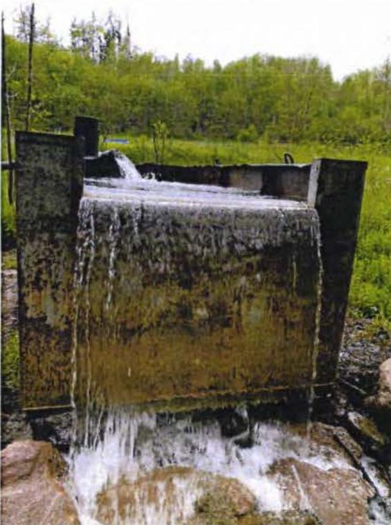
Foto 7: Abfluss von  $100 \text{ m}^3/\text{h}$  während des PV aus dem Absetzcontainer über die Steinpackung in die Bracht am 10.05.2023.
