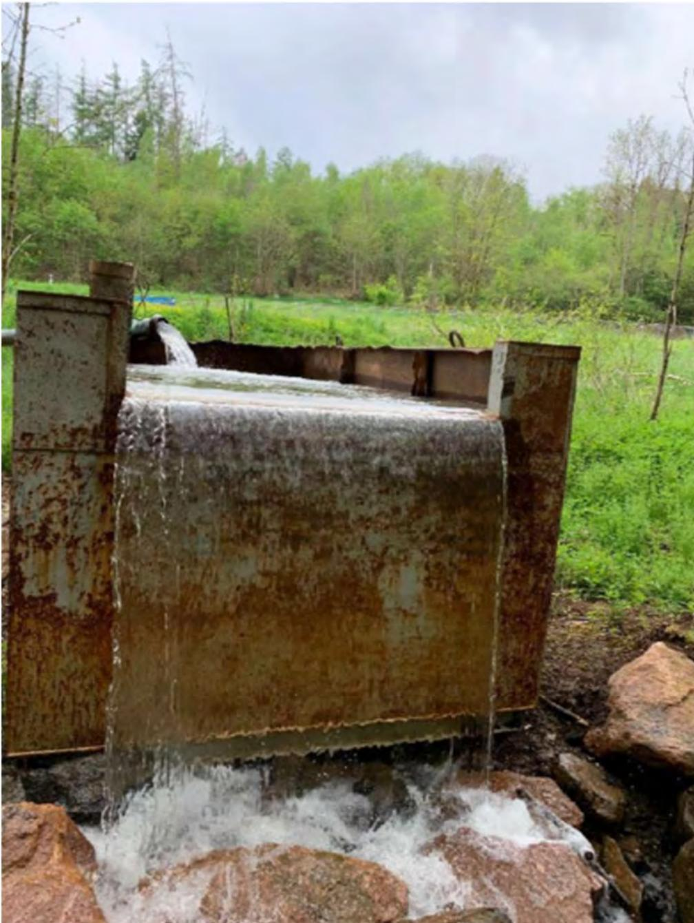
Abb. 4: Ablauf des Wassers aus dem Pumpversuch
